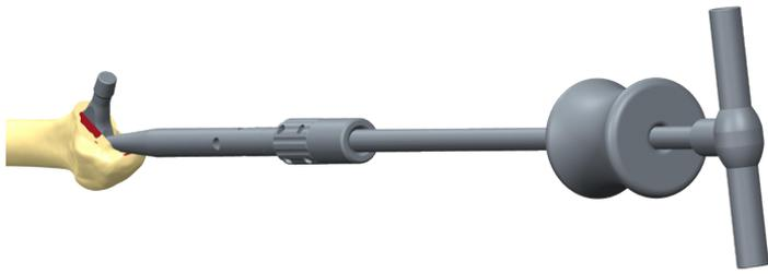
Der Revisions-Gleithammer wird nun daran angeschlossen. Der Drehverschluss muss nach der Koppelung vollständig verschlossen sein.
